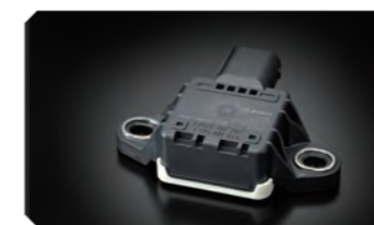
IMU/6 direzioni, lungo 3 assi, beccheggio, rollio e imbardata
